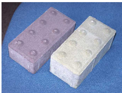
Obr. 1 Betonová zámková dlažba s výstupky pravidelného tvaru
