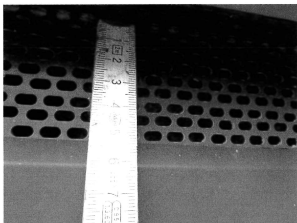
foto/54/ Výška přívodního otvoru
